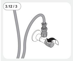
• 打开冷水管上的角阀。
