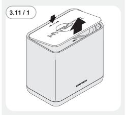
• 取下设备盖板。 为此,按压压力点,然后抓住设备盖板边缘的下方。
