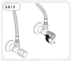
• 关闭冷水管上的角阀。
