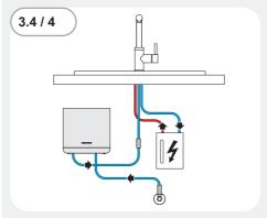
连接一个 2 通水阀并使用热水器。
