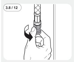
手动将连接件 (H) 或 (G) 拧到纯净水的 水阀接头上。
