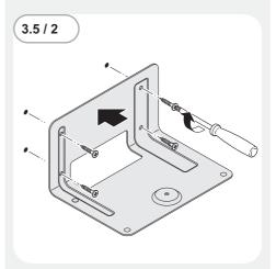
• 用四个螺丝 (O) 固定墙上托架 (C)。
