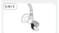
• 关闭冷水管上的角阀。
