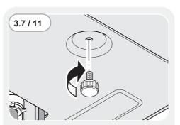
• 从下方将滚花螺丝 (N) 穿过墙上托架 (C) 拧入设备。
