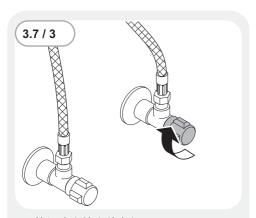
• 关闭冷水管上的角阀。
