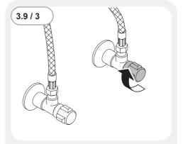
• 关闭冷水管上的角阀。
